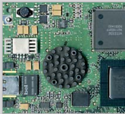
Il grosso dissipatore di calore copre uno dei potenti chip custom
